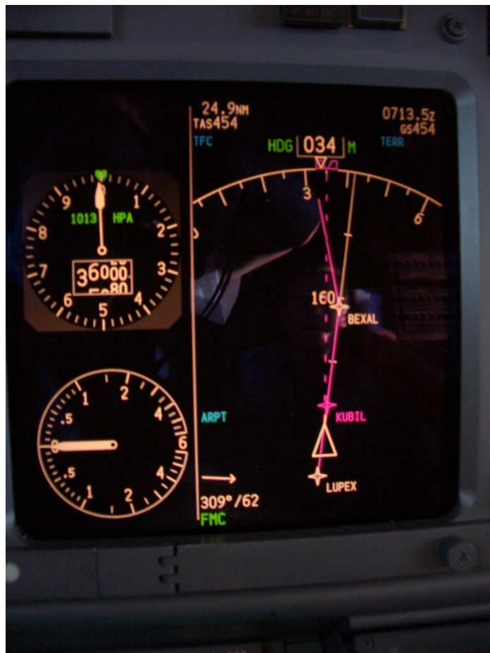
**Avión B-727**, vuelo Madrid-Tenerife. Se observan diferencias de indicación entre las brújulas del comandante y del copiloto. Se localiza a un pasajero con una videocámara activada; al apagarla desaparece la discrepancia entre ambos sistemas.
