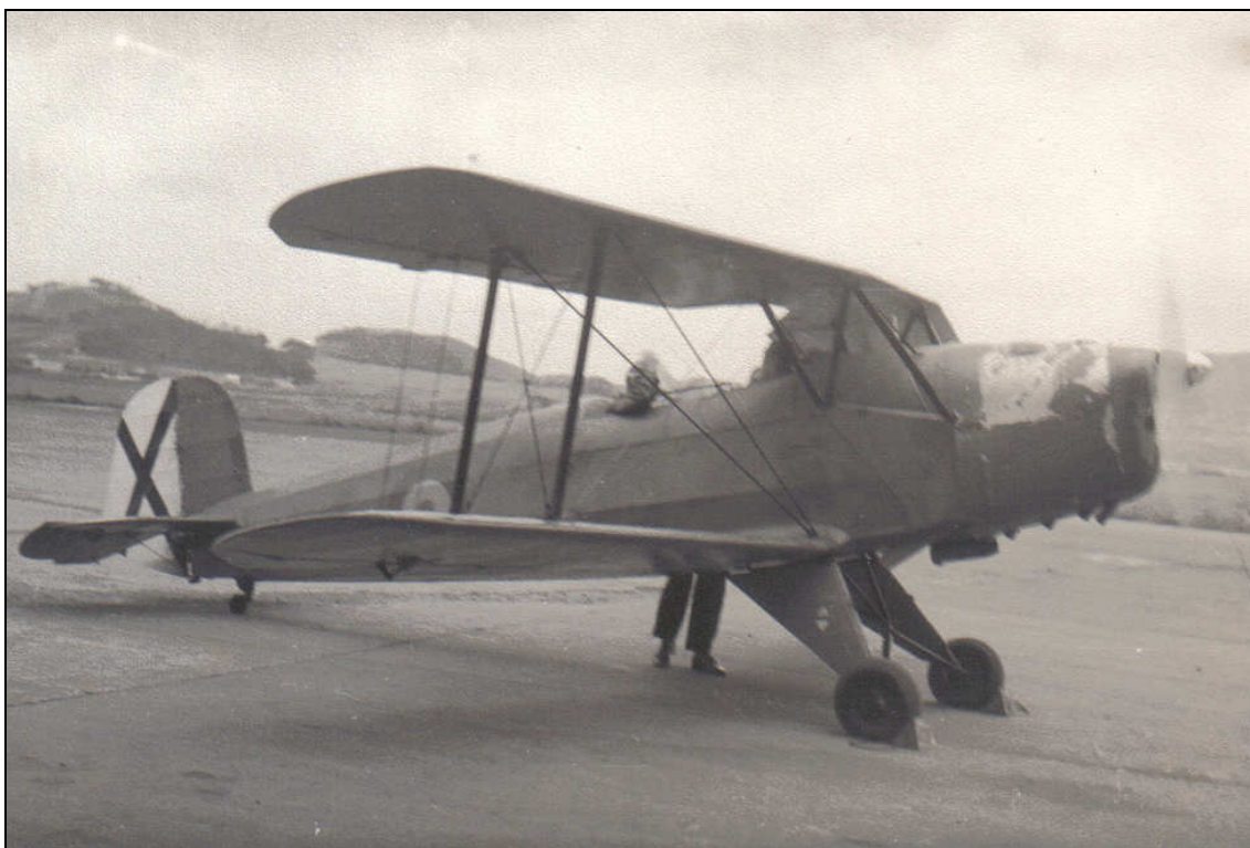
Bücker Bü-E3B con motor español modelo Tiger G4 a B 135 CV de ENMASA (Empresa Nacional de Motores Aeronáuticos SA). La versión alemana Bü-E3 tenía un motor alemán de 115 CV.
