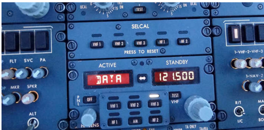
Equipo de radio de un Boeing 737-800 recibiendo datos en la banda VHF. Foto Guillermo Hernández
